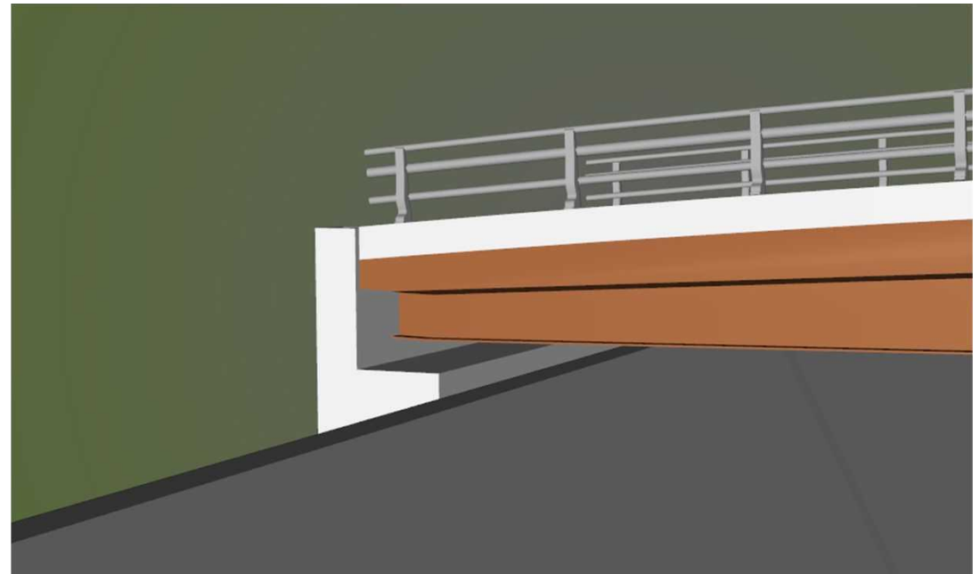
護岸工位置及び桁下高さの確認
